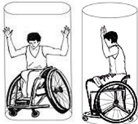
Figure 6 – Principe du cylindre
